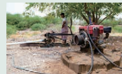
支援したエンジンを使って井戸から水を汲み上げる。
