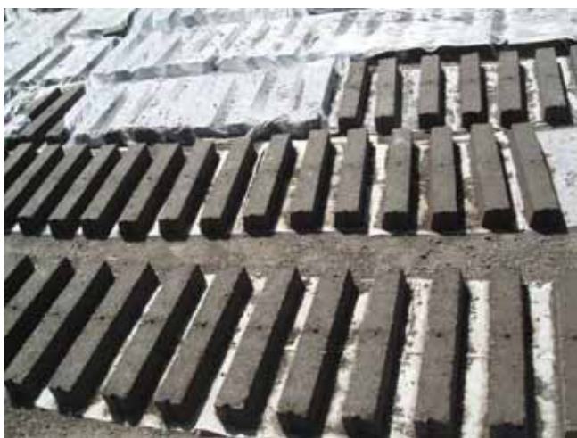
壁用ブロックを干しているところ
