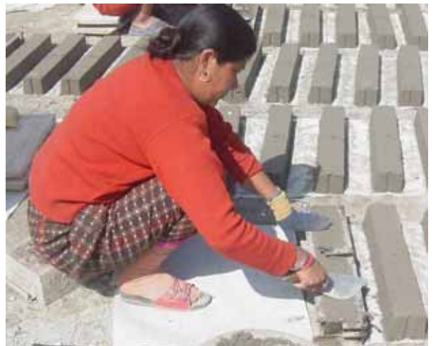
壁用ブロックの製造。セメントを少しずつハンマーで叩きながらモールド(型)に押し込んでいく。黙々と作業を続ける女性らの姿が印象的。
